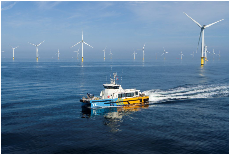
Das Hydrocat 48 der Werft Windcat Workboats ist das erste Crew Transfer Vessel mit emissionsarmem Dual Fuel-Wasserstoffantrieb.
