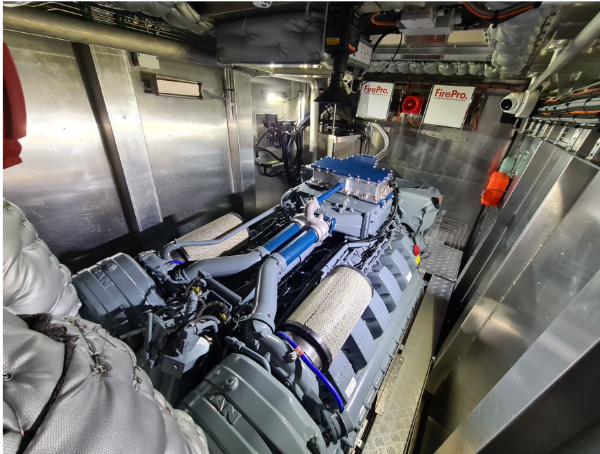
Kompakter Dieselmotor für den Dual Fuel-Betrieb. Der MAN D2862 LE448 mit 749 kW (1.029 PS) bei 2.100 min -1 .
