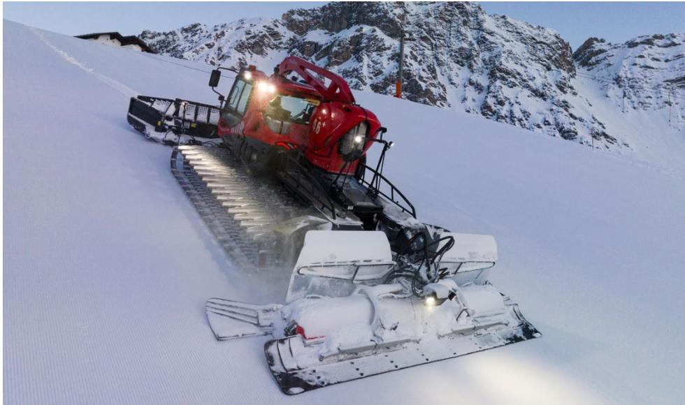
*Der MAN D3876 für den PistenBully 800 ist zusätzlich auf Kaltstartfähigkeit, den Einsatz bis 2.500 Höhenmeter ohne Leistungsreduktion sowie extreme Schräglagen modifiziert.*
