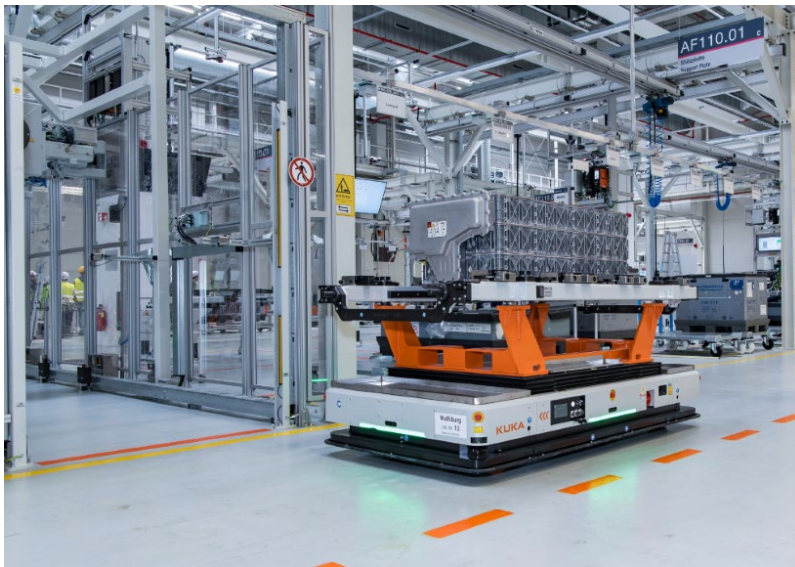
Das MAN BatteryPack wird am Standort Nürnberg entwickelt und gefertigt: Die modulare Energiespeicherlösung – verfügbar in verschiedenen Formfaktoren – vereint hohe Leistungsdichte mit robuster Bauweise und ist ideal für mobile und industrielle Anwendungen.
