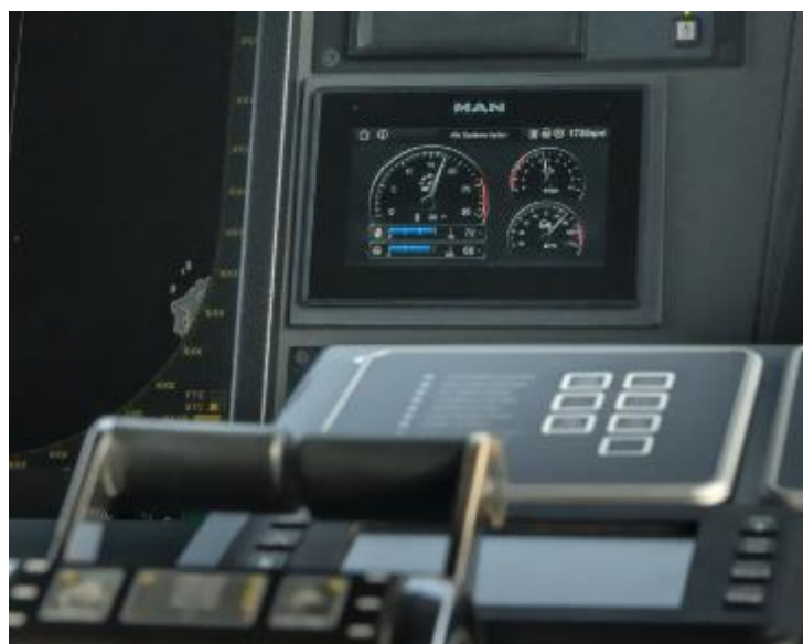
Das iSea Brückendisplay zeigt die Bedienwerte von bis zu sieben Peripheriegeräten
