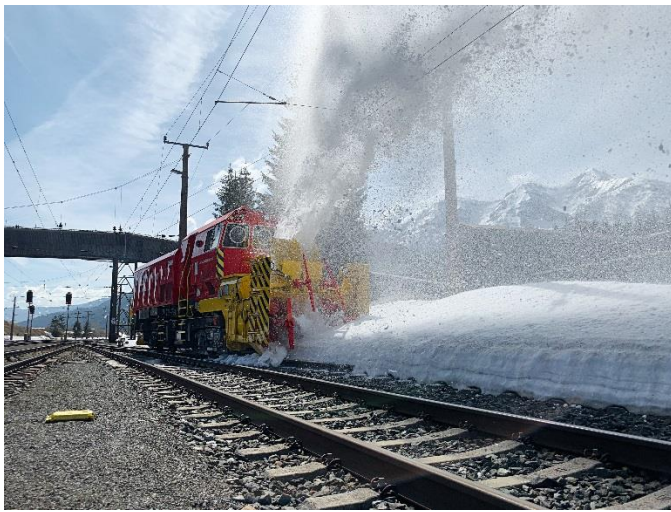
Die Schmidt Beilhack HB1100S räumt dank MAN-Power bis zu 10.000 Tonnen Schnee pro Stunde
