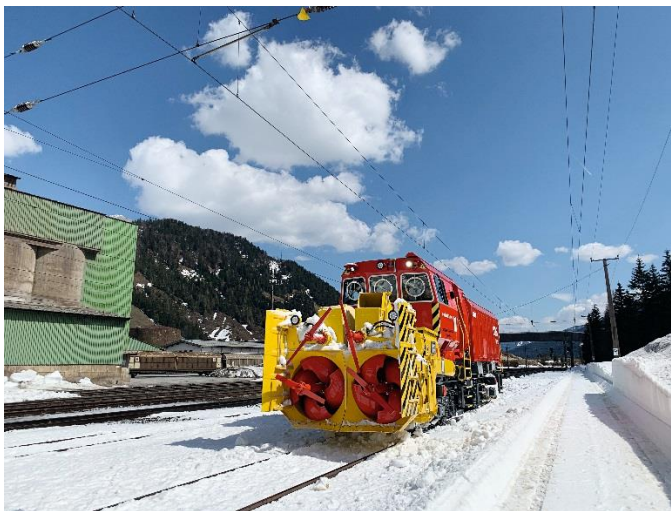
Schmidt Beilhack HB1100S auf der Teststrecke in Hochfilzen. Gut zu erkennen ist die Schleuder im Vordergrund, für die alleine die Leistung einer der beiden 793 kW starken MAN-Motoren benötigt wird.
