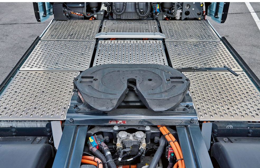
Dank E-Achse kann der Iveco brutto 738 kWh in neun Batteriepaketen bunkern
