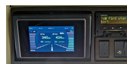
Schlecht ablesbares Überkopf-Display
