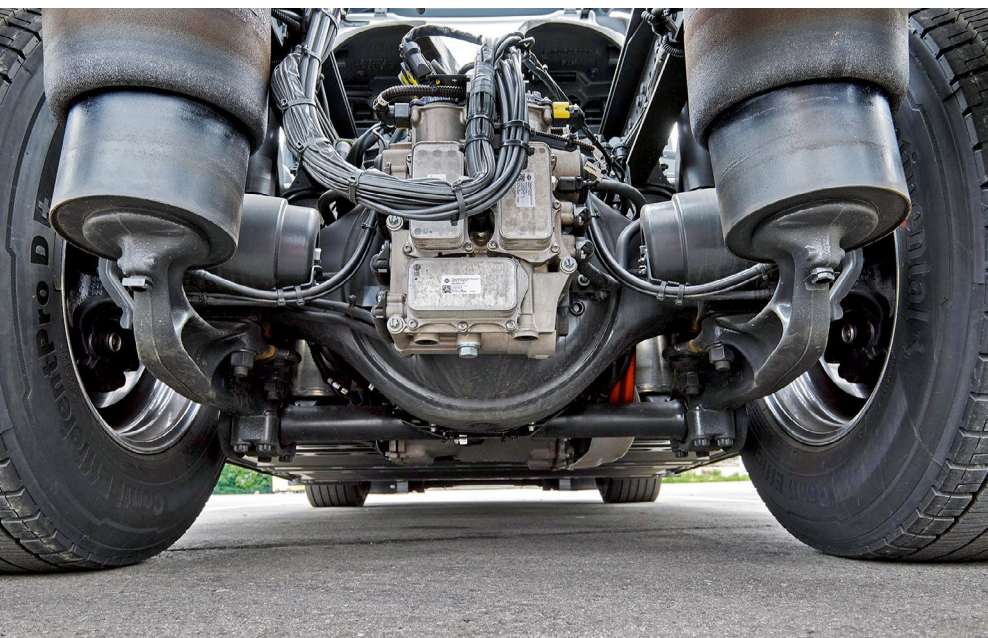
E-Achse mit zwei Elektromotoren plus automatisiertem Vierganggetriebe
