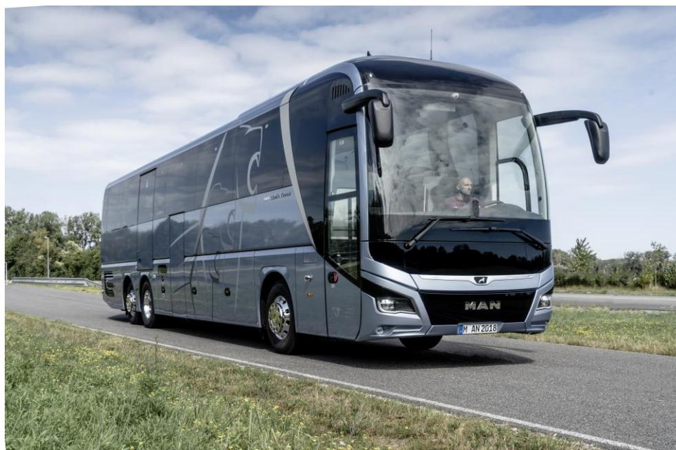
Grâce à sa suspension de nouvelle génération, le MAN Lion's Coach filtre efficacement les vibrations et assure un excellent confort à bord. Il est accessible aux PMR grâce à un élévateur UFR optionnel. Le plancher plat sans podest accorde une grande liberté pour l'aménagement de l'autocar, la répartition de ses sièges, l'installation de tables ou celle d'autres équipements.
