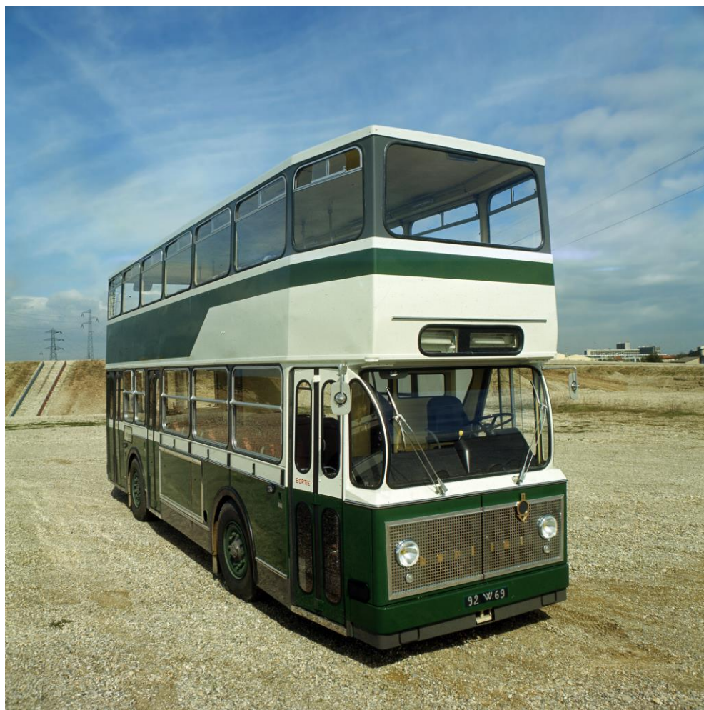
1967 - Berliet PCMRE équipé d'un moteur MAN @Berliet
